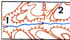
Овраги и промоины: 1) шириной в масштабе карты более 1 мм; 2) шириной 1 мм и менее (в числителе— ширина между бровками, в знаменателе— глубина в метрах)
